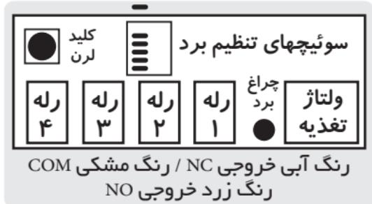
سیم بندی: ترمینال جهت اتصال منبع تغذیه است در صورت استفاده از ولتاژ DC رنگ قرمز به مثبت تغذیه وصل شود. کانکتورهای ۳ پین (ترمینال ۳ تایی) خروجی رله می باشد.
